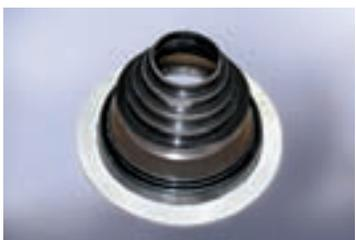
Резиновый уплотнитель круглого сечения для битумных плоских и скатных кровель применяется для герметизации кровельных проходок (антенные трубы, крепление кондиционеров и т.д.).
