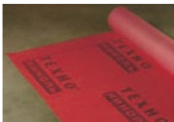
**Пароизоляционная пленка для скатных кровель и стен** — это трехслойная структура пароизоляции для скатных кровель ТехноНИКОЛЬ обеспечивает прочность и надежность. Верхний и нижний слои представляют собой полотна нетканого полипропилена, которые обеспечивают прочный каркас для среднего «рабочего» слоя. Средним слоем является полипропиленовая пленка с функцией контроля паропроницаемости. Слои пароизоляции соединены по технологии низкотемпературной ультразвуковой сварки.
