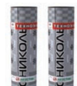
**Техноэласт АКУСТИК** — материал рулонный звукоизоляционный прокладочный. Изготавливается на основе специального звукоизоляционного стеклохолста, на одну сторону которого нанесен слой битумно-полимерного вяжущего.
