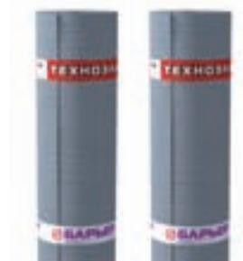
**Техноэласт БАРЬЕР** — это гидроизоляционное полотно, состоящее из полиэфирной основы и нанесенного на него с двух сторон самоклеящегося битумно-полимерного вяжущего. Сверху материал защищают толстой полимерной пленкой, снизу закрывают силиконизированной антиадгезионной пленкой.
