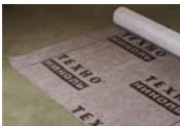
**Мембрана ТехноНИКОЛЬ супердиффузионная** — это трехслойная микропористая мембрана. Верхний и нижний слои представляют собой полотна нетканого полипропилена, которые обеспечивают прочный каркас для среднего «рабочего» слоя. В качестве среднего слоя выступает полипропиленовая пленка, которая, благодаря своим уникальным свойствам, обеспечивает диффузию водяного пара, но препятствует прохождению воды.
