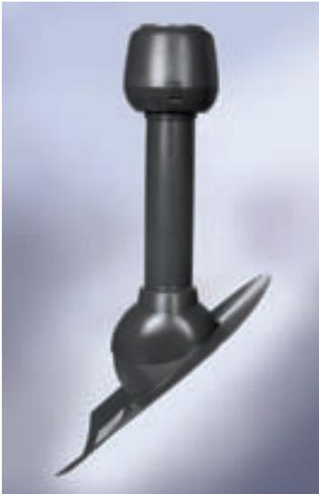
**ПРИМЕНЕНИЕ:** создает перепад давления в подкровельном пространстве, в результате чего влага, испаряющаяся из утеплителя выводится за счет движения воздушных потоков. Устанавливается на расстоянии 0,5–0,8 м от конька кровли, при этом на свесах обеспечивается приток воздуха. Один аэратор обеспечивает вентиляцию 5 м<sup>2</sup> кровли, при условии, что высота вентилируемого подкровельного пространства равна 5 см.
