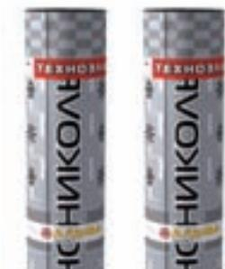
**Техноэласт АЛЬФА** — это материал, который состоит из полиэстера, совмещенного со специальным газоизоляционным алюминиевым экраном, с обеих сторон которого нанесено битумно-полимерное вяжущее. Благодаря металлическому экрану внутри материала Техноэласт АЛЬФА обладает высокой степенью защиты подземных помещений от распространенных опасных инертных газов, таких как радон и метан.
