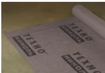
**Мембрана ТехноНИКОЛЬ супердиффузионная Оптима** — это трехслойная микропористая мембрана. Верхний и нижний слои представляют собой полотна нетканого полипропилена, которые обеспечивают прочный каркас для среднего «рабочего» слоя. В качестве среднего слоя выступает полипропиленовая пленка, которая, благодаря своим уникальным свойствам, обеспечивает диффузию водяного пара, но препятствует прохождению воды.
