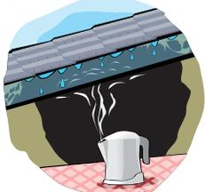
За счет того, что металл резко реагирует на перепад температур, на нижнем слое металлочерепицы постоянно образуется конденсат, который вызывает коррозию металла.
